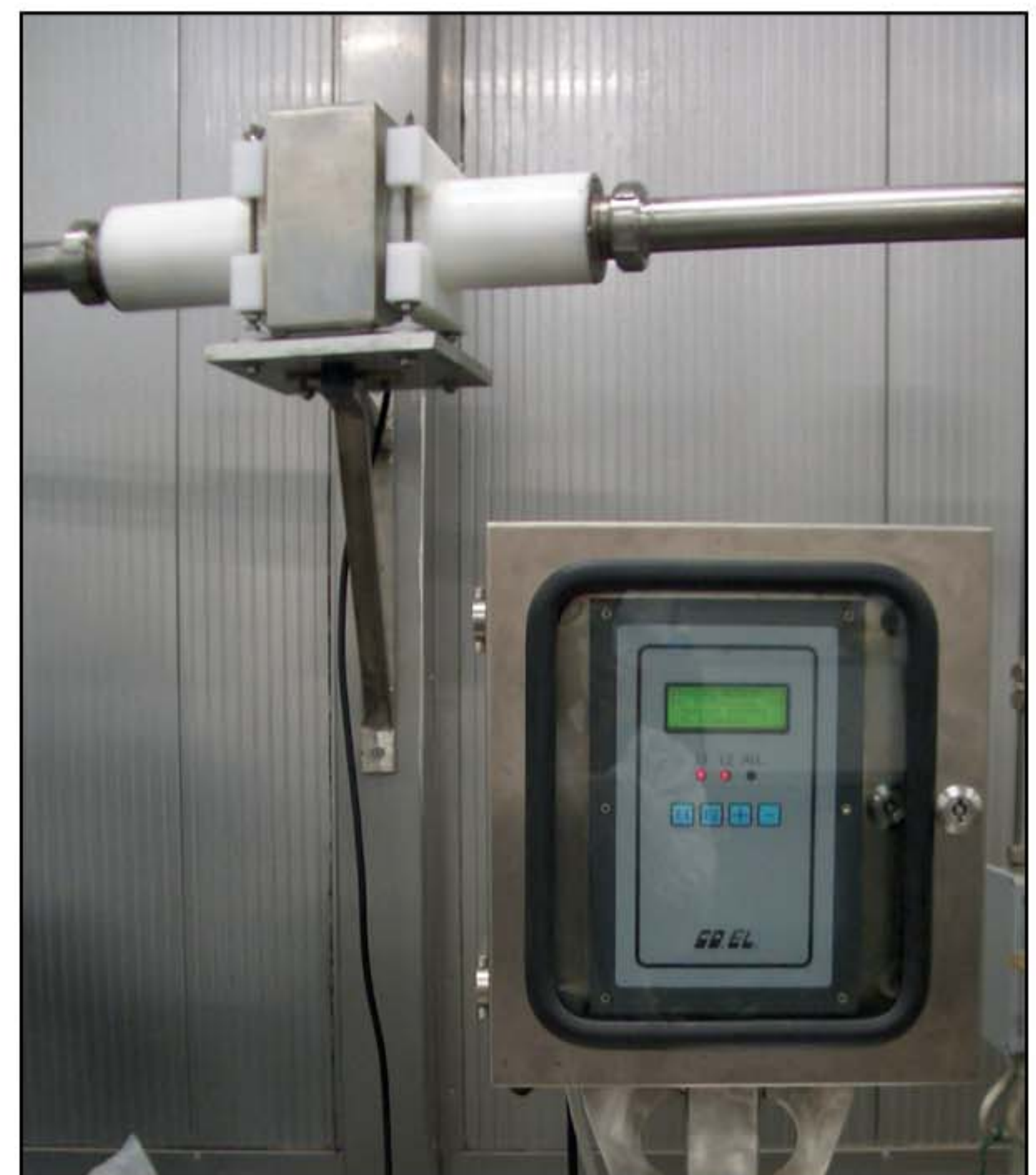
SONDA TOR-AL CON CENTRALINA COMP-AL STAGNA PER CONTROLLO SUGHI PRONTI
